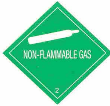
รูปที่4 ป้ายกำกับการขนส่งของแก๊สไม่ติดไฟ
